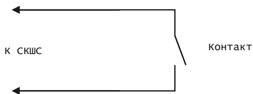
Рис. 6 Схема включения ШС без контроля КЗ и обрыва
