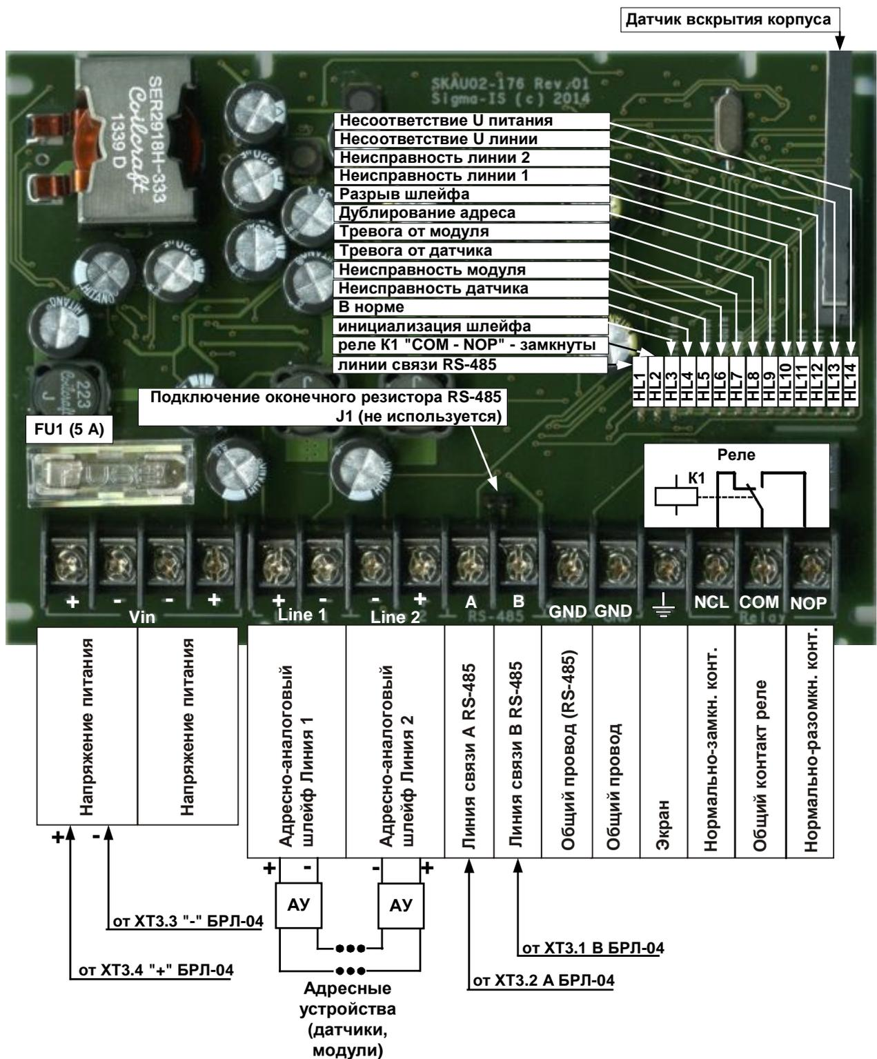
Рис. 4 Внешний вид модуля SKAU-02(A1) . Подключение.
