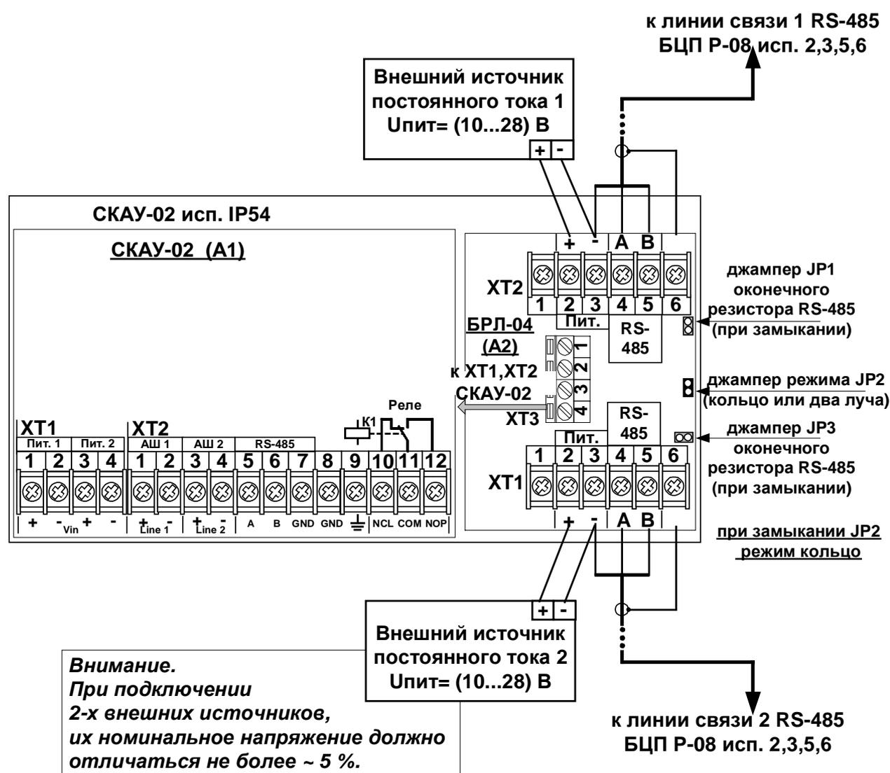
Рис. 2 Применение (подключение) SKAU-02 IP54 в режиме кольца линий связи RS-485
