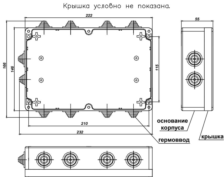
**Рис. 3 Внешний вид, габаритные и присоединительные размеры**
