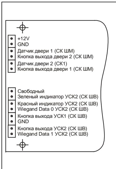
**Рис. 2 Колодка подключения ПУ**
