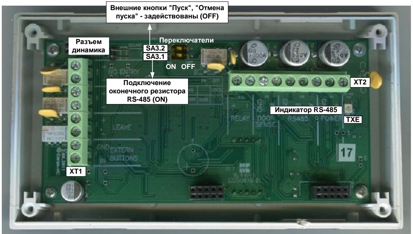
Рис. 2 Расположение элементов на плате ППО
