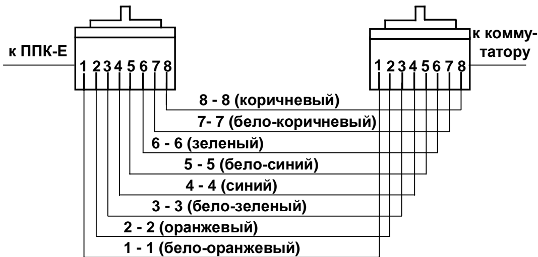
б) Прямой кабель (соединение ППК-Е и коммутатора)
