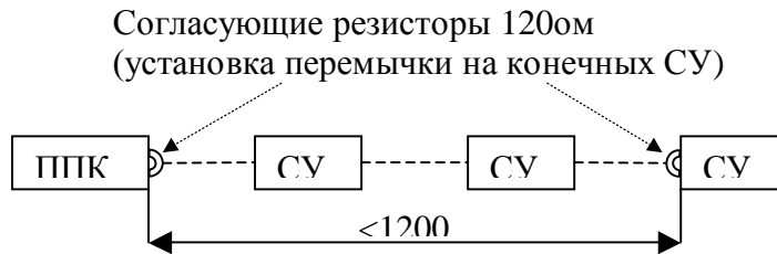
Рис. 4 Подключение сетевых устройств на линию RS-485.
