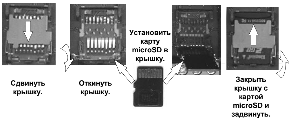
Рис. 6 Установка карты памяти microSD
