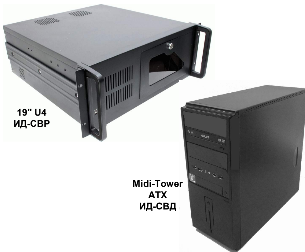
Рис. 1 Внешний вид видеосерверов ИД-СВР и ИД-СВД (форм-факторы).
