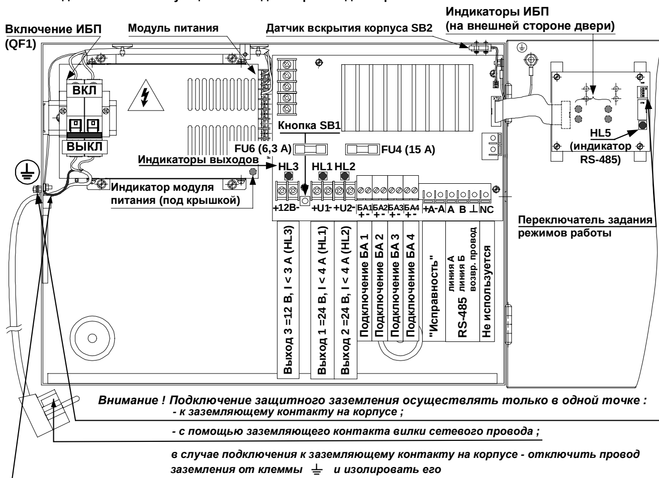
Рис. 3 Внешний вид ИБП-1224 исп. 2 с открытой дверью (подключение)
