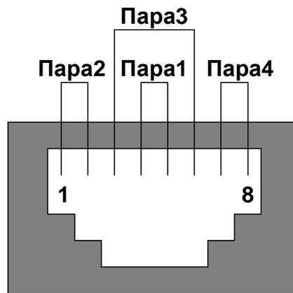
Рис. 6. Разводка RJ-45
