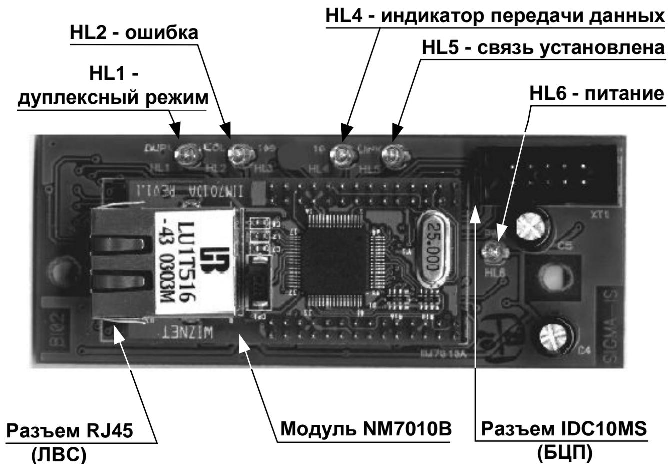
Рис. 3. Конструкция БИ-03.
