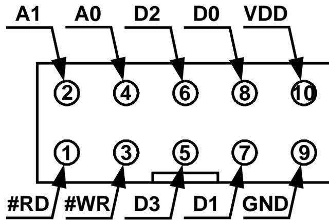
Рис. 5. Назначение контактов разъема XT1.
