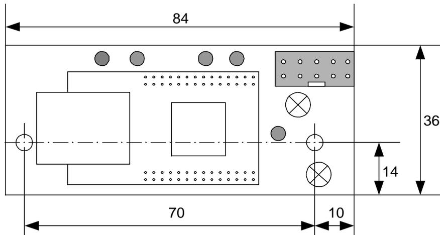
Рис. 4. Габаритные и присоединительные размеры БИ-03.
