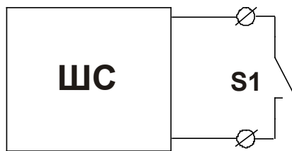
Рис. Схема 6 Подключение НР контактов без контроля целостности линии связи.
