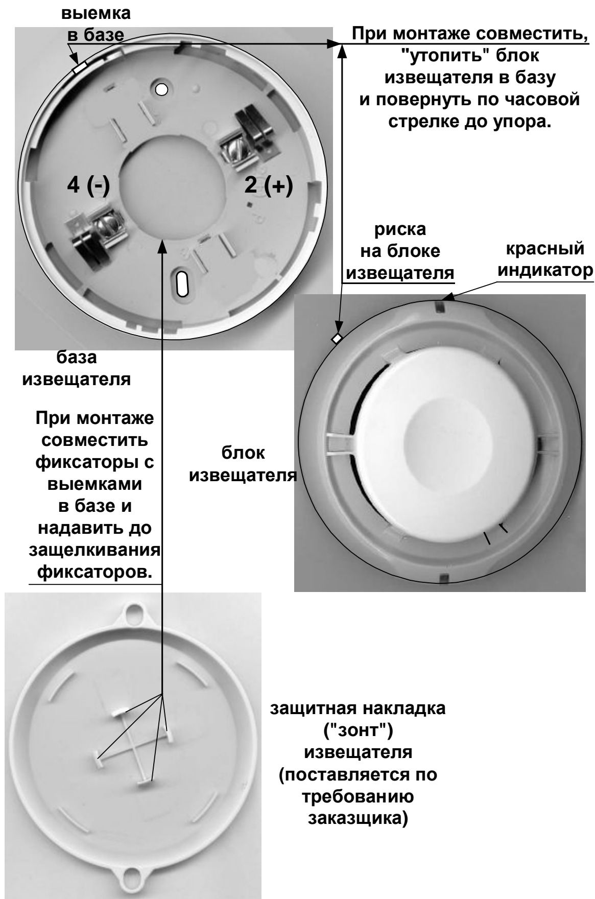
Рис. 1 А2ДПИ «Рубикон» (база, блок извещателя, «зонт»)
