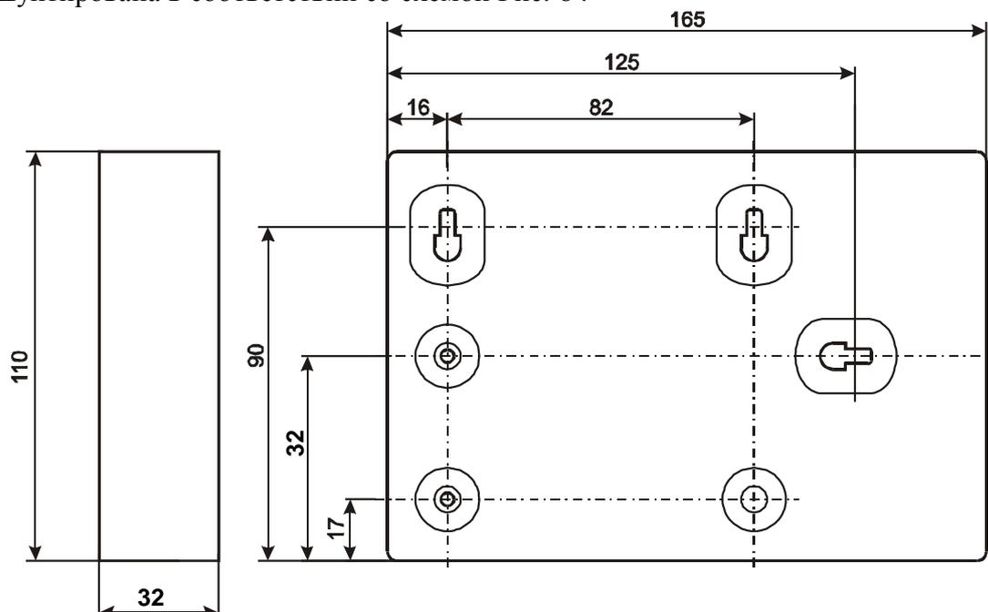
**Рис. 3** Внешний вид и габаритные размеры СК-01 в исп. IP20
