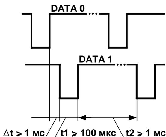
Рис. 1 Характеристики импульсов интерфейса Wiegand (Data 0, Data 1)
