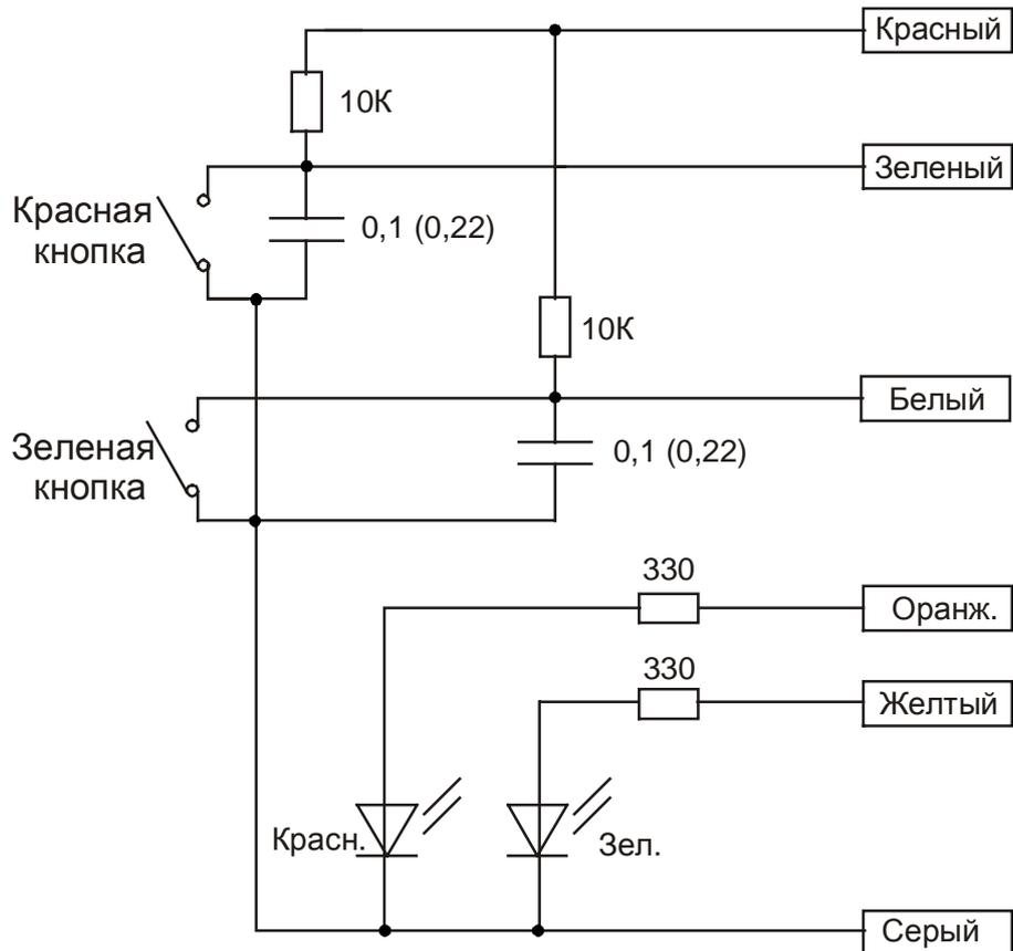
Рис. 8 Принципиальная схема подключения устройства постановки-снятия
