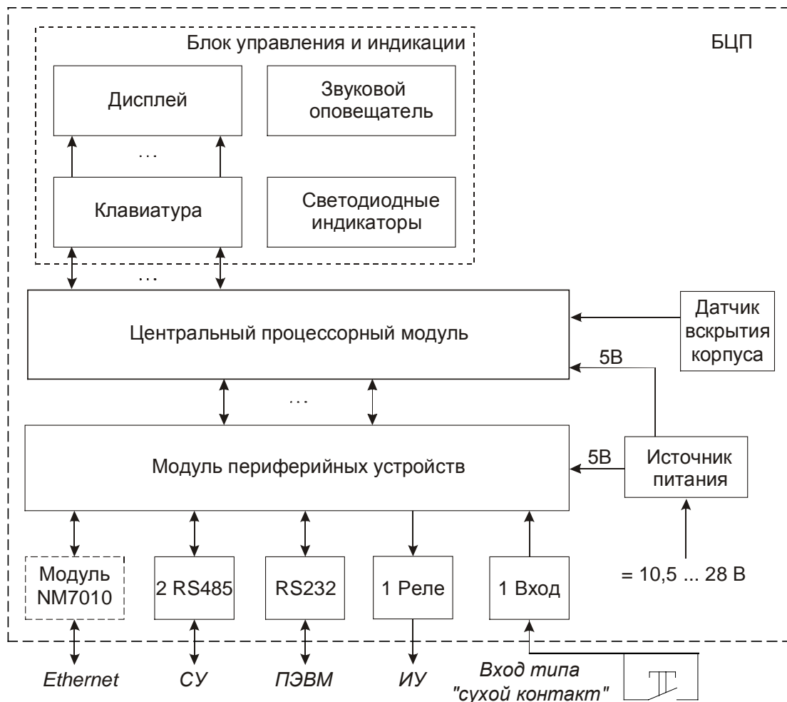
Рис. 6 Электрическая структурная схема БЦП Р-08 исп. 6
