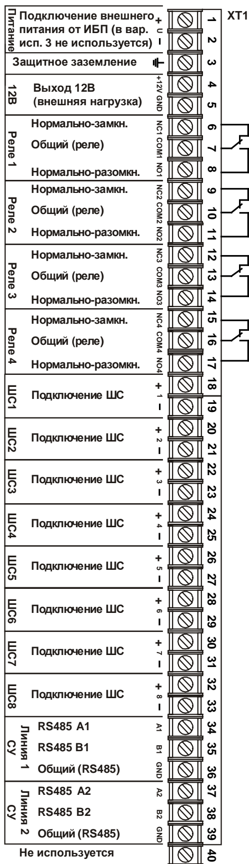
Рис. 17 Схема подключения БЦП (исп. 2)
