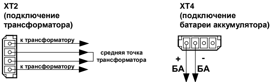
Рис. 30 Разъемы XT2 и XT4 исп. 3
