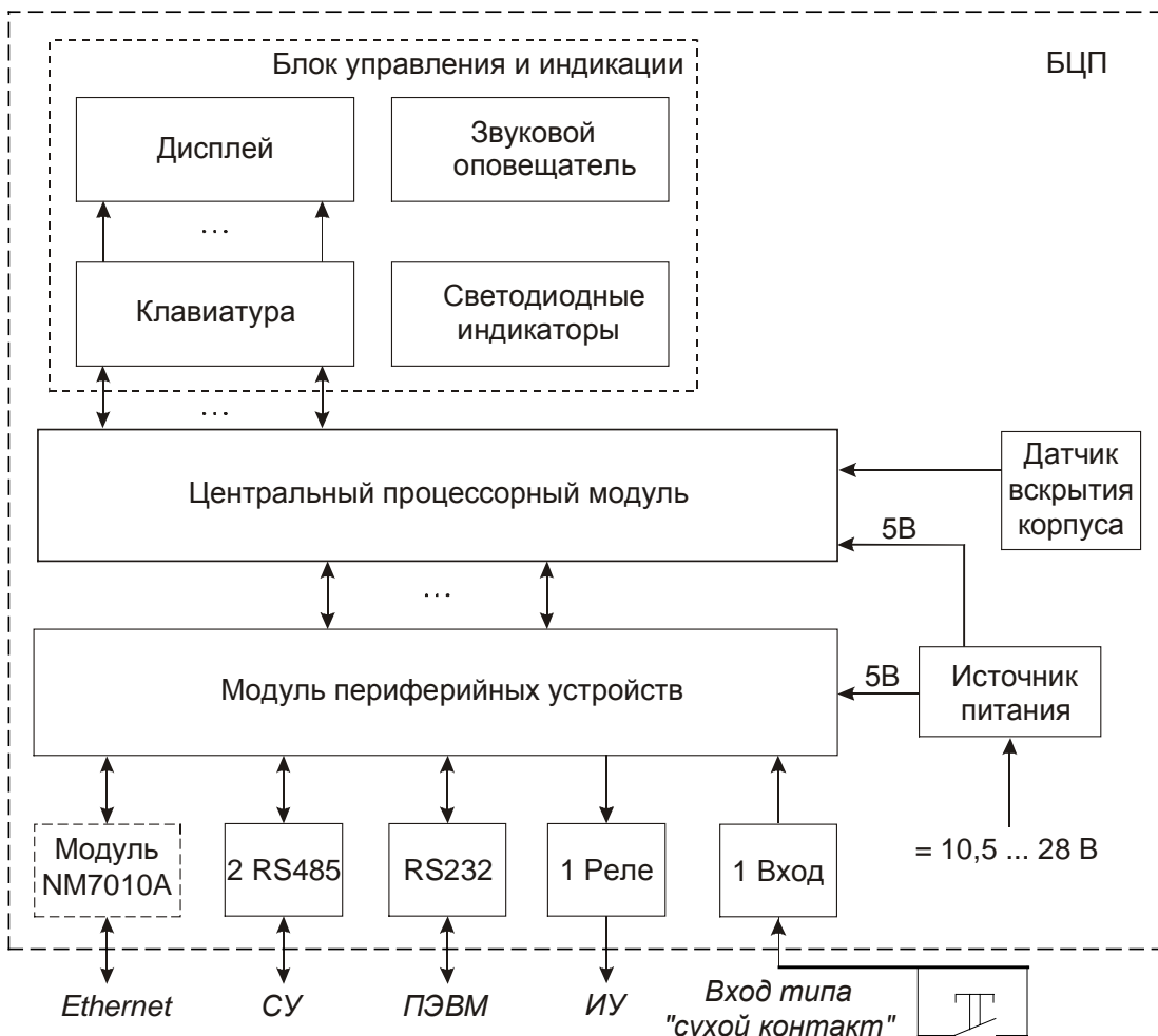
Рис. 6 Электрическая структурная схема БЦП P-08 исп. 6
