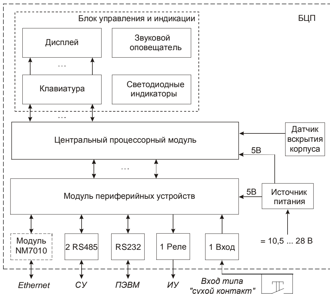
Рис. 6 Электрическая структурная схема БЦП Р-08 исп. 6
