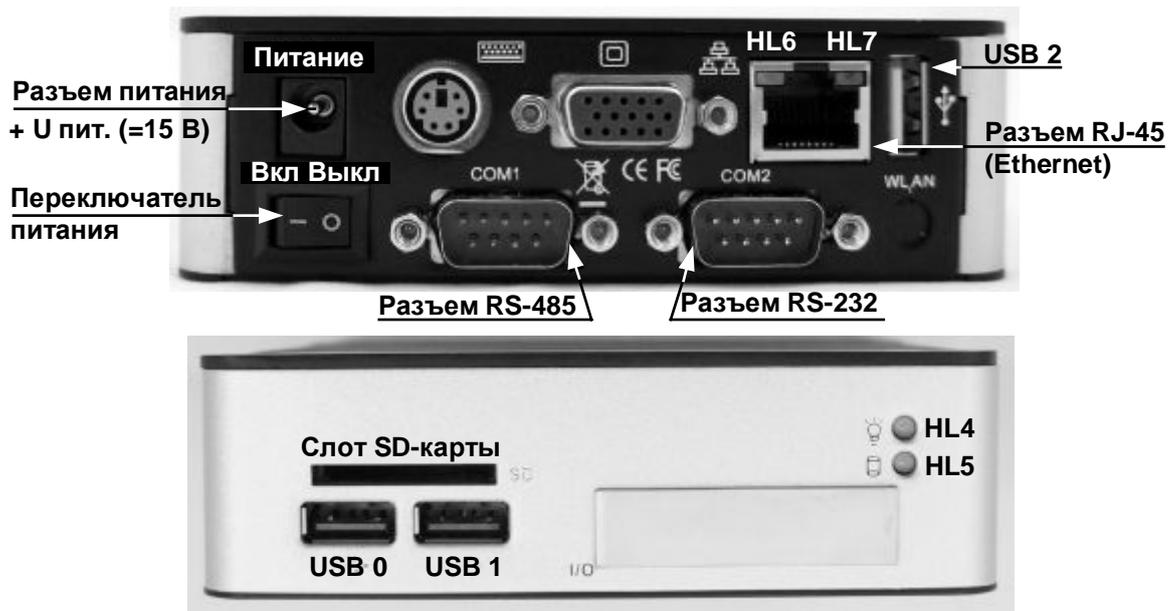
Рис. 4 Модуль процессорный, разъемы, индикаторы.
