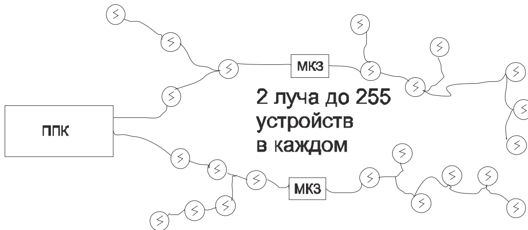
Рис. 6 Подключение адресного шлейфа в режиме «два луча».
