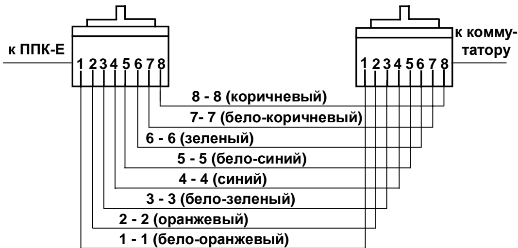
б) Прямой кабель (соединение ППК-Е и коммутатора)
