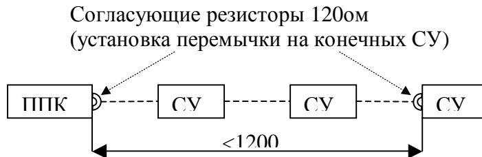
Рис. 4 Подключение сетевых устройств на линию RS-485.
