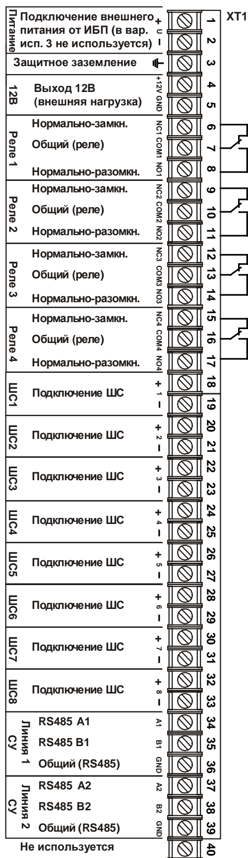
Рис. 32 Назначение разъемов ХТ1 БЦП исп. 2,3
