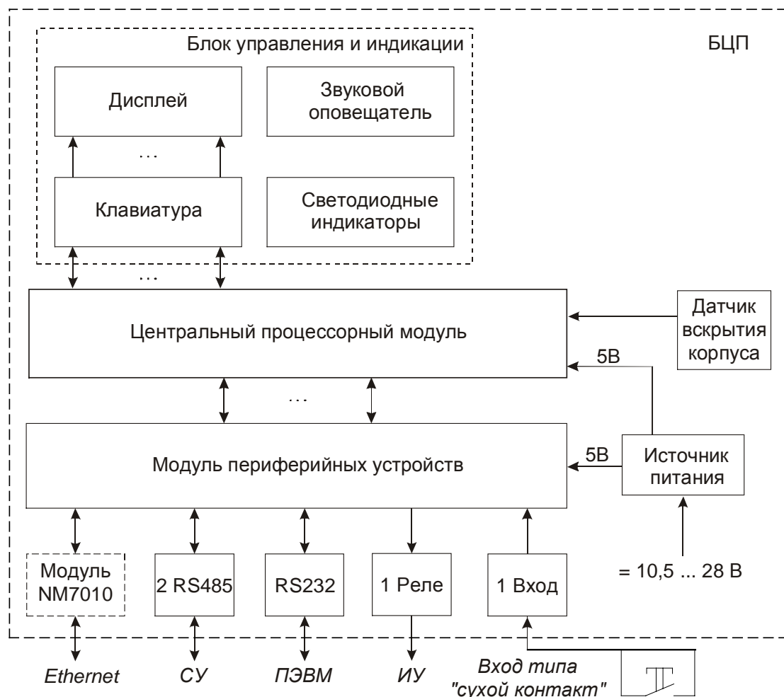
Рис. 6 Электрическая структурная схема БЦП Р-08 исп. 6
