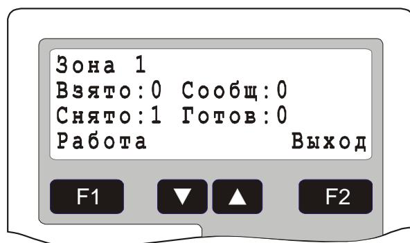
**Рис. 7 Окно работы с зоной, имеющей охранные ШС**
