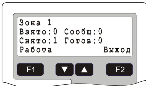
**Рис. 7 Окно работы с зоной, имеющей охранные ШС**
