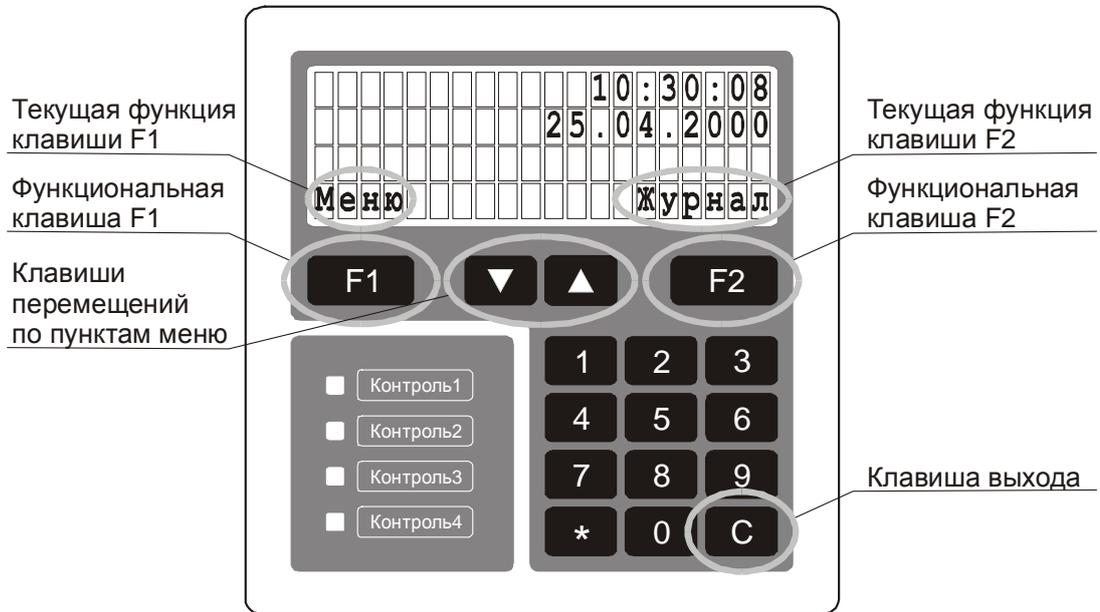
Рис. 1 Общий вид консоли управления БЦП
