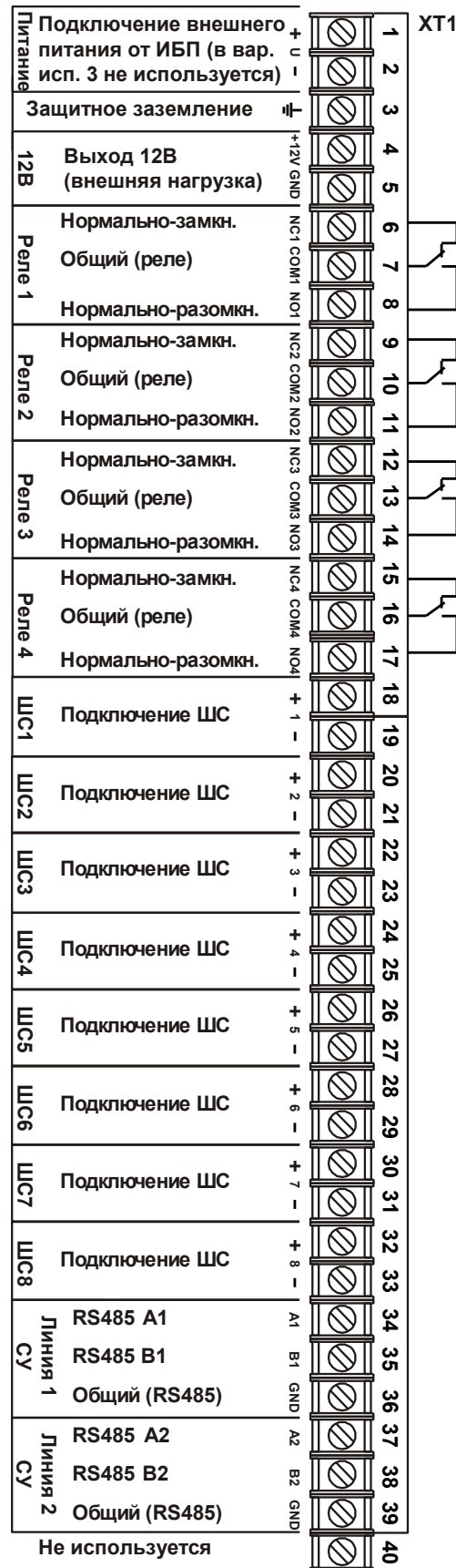
Рис. 32 Назначение разъемов ХТ1 БЦП исп. 2,3
