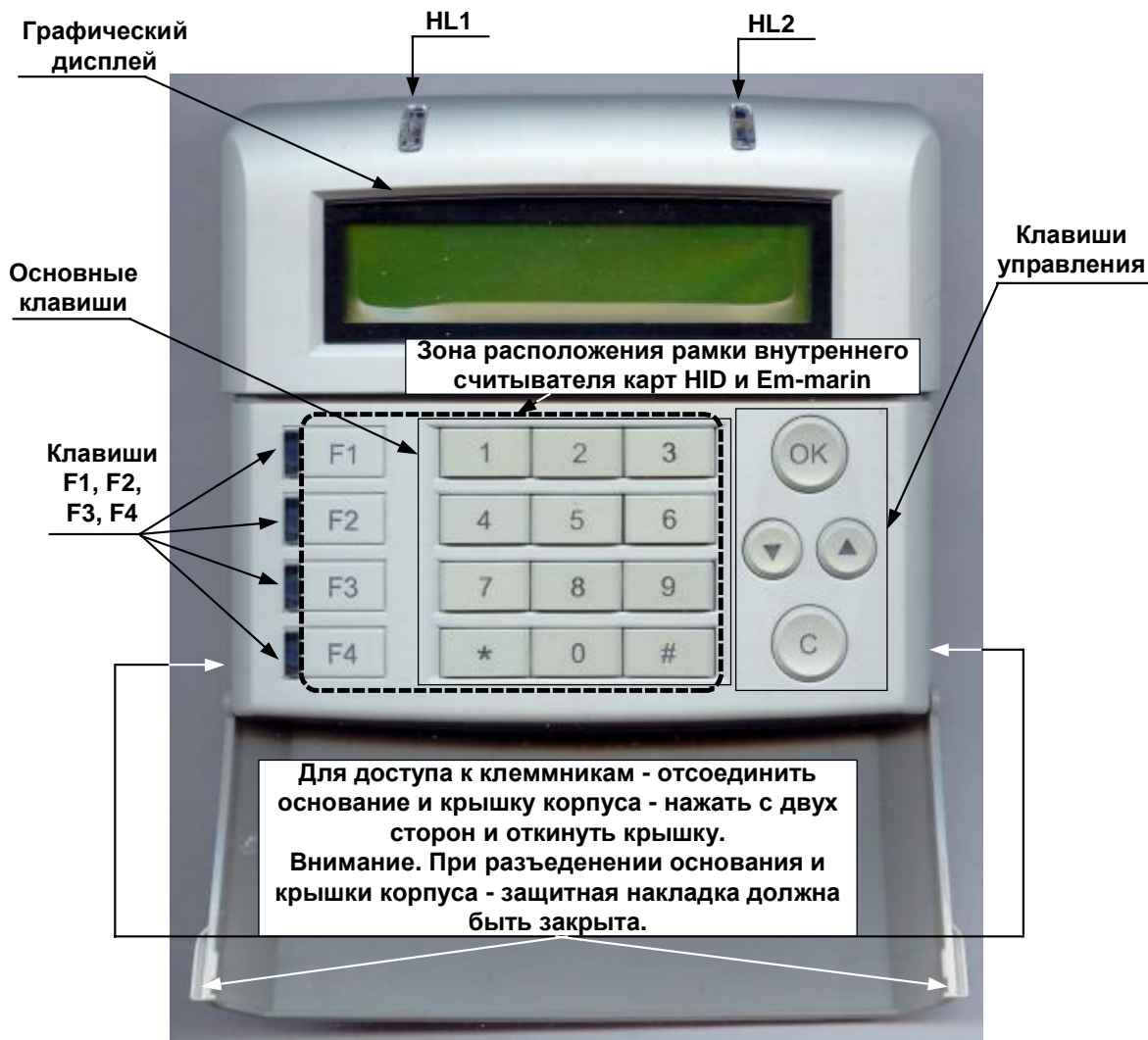
Рис. 2 Внешний вид ПУО (с откинутой накладкой)
