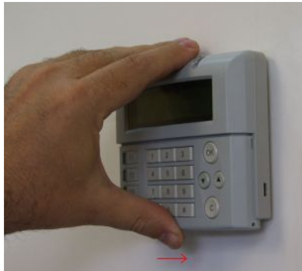
Рис. 4 Снятие и установка крышки ПУО
