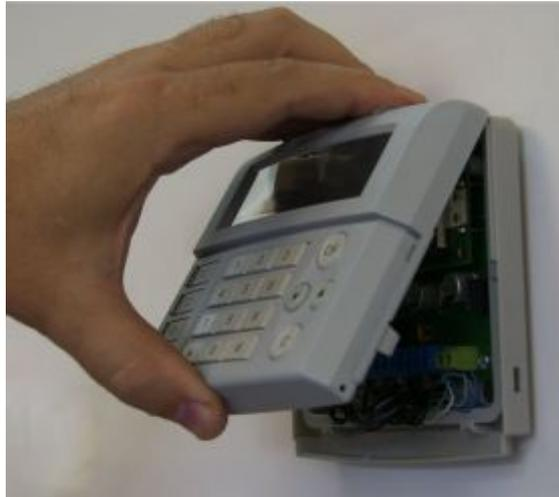
2. Обратить особое внимание на аккуратное зацепление соответствующих элементов корпуса и совмещение разъема клавиатуры (помечены на рис.).
