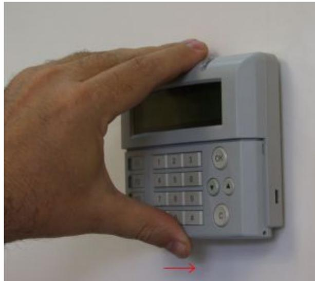
**Рис. 4 Снятие и установка крышки ПУО**
