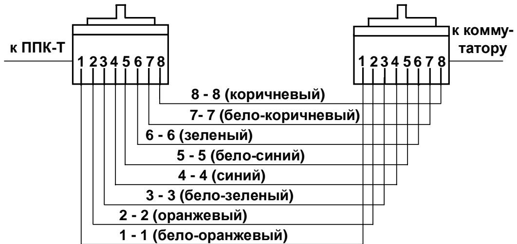
б) Прямая кросс-разводка (ППК-Т и коммутатор)
