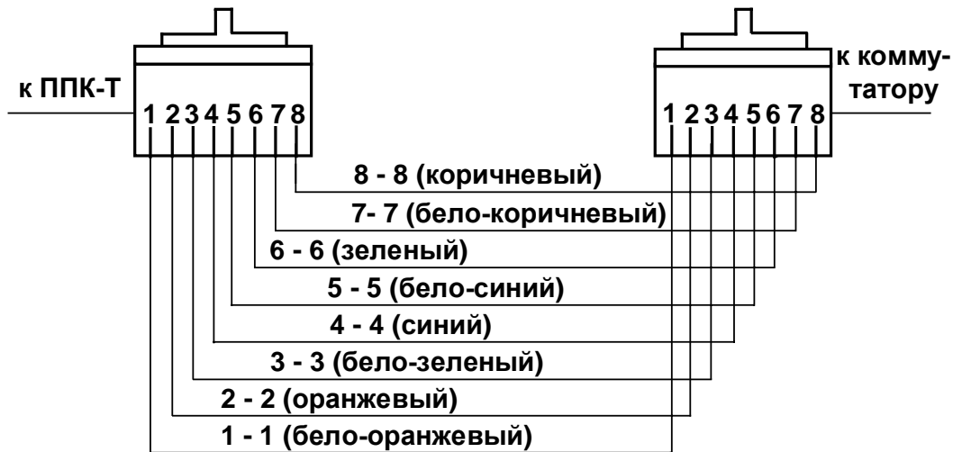
б) Прямая кросс-разводка (ППК-Т и коммутатор)
