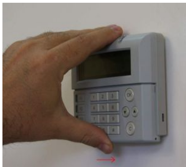
Рис. 5 Снятие и установка крышки ППК
