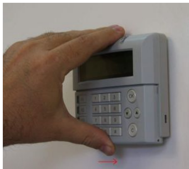
Рис. 5 Снятие и установка крышки ППК
