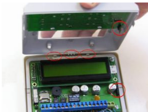
Рис. 5 Снятие и установка крышки ППК
