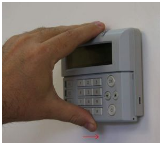
Рис. 5 Снятие и установка крышки ППК
