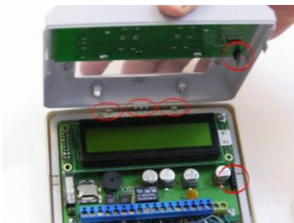
Рис. 5 Снятие и установка крышки ППК
