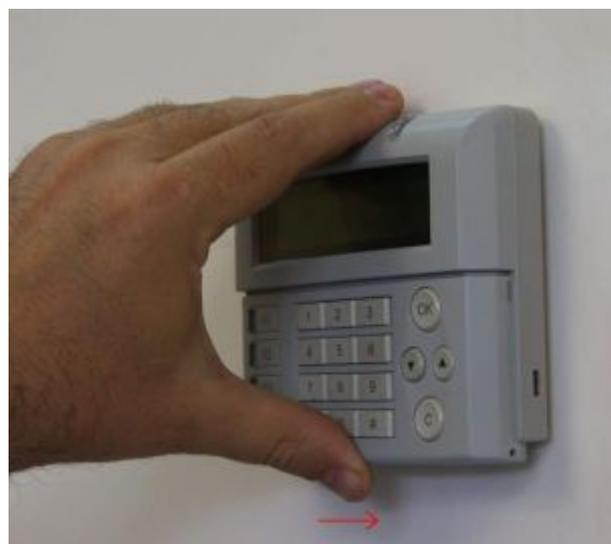
**Рис. 5 Снятие и установка крышки ППК**
