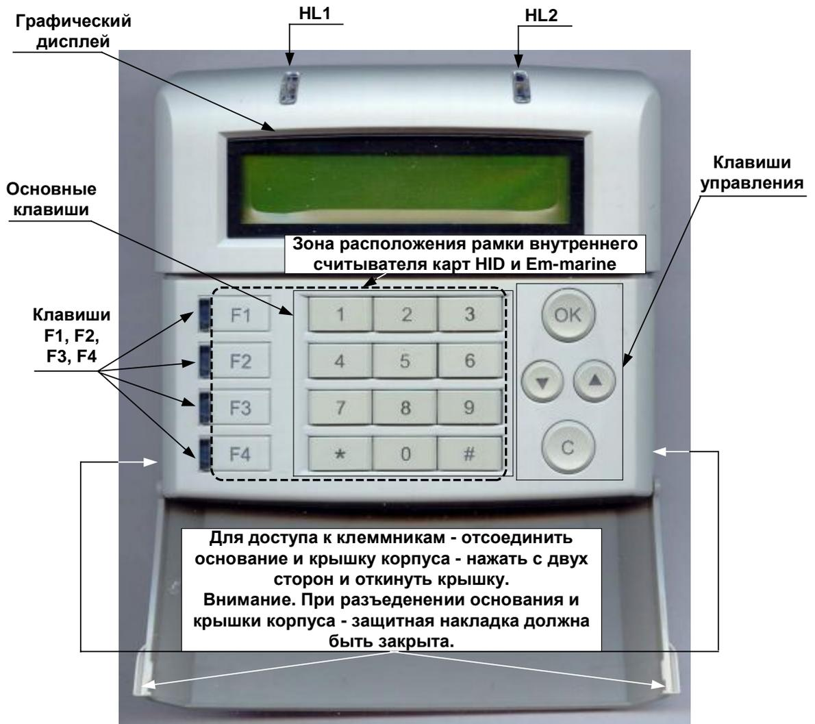
**Рис. 3 Внешний вид ППК (ППК-М) с откинутой накладкой.**
