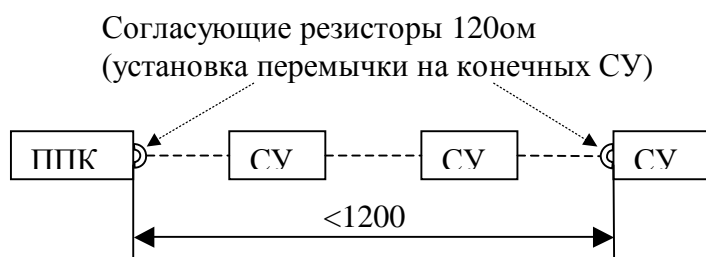
Рис. 4 Подключение сетевых устройств на линию RS-485.
