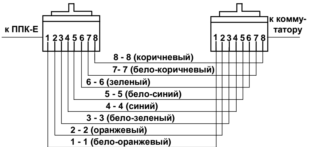
б) Прямой кабель (соединение ППК-Е и коммутатора)
