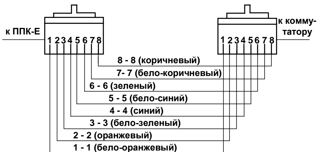
б) Прямой кабель (соединение ППК-Е и коммутатора)
