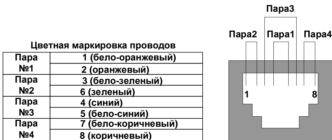
Рис. 8 Подключение ППК и ПЭВМ (Ethernet)
