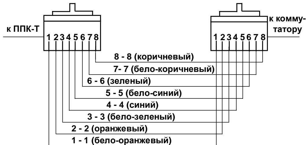
б) Прямая кросс-разводка (ППК-Т и коммутатор)
