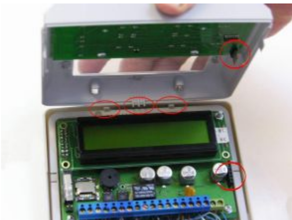
Рис. 5 Снятие и установка крышки ППК
