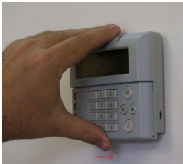
Рис. 5 Снятие и установка крышки ППК
