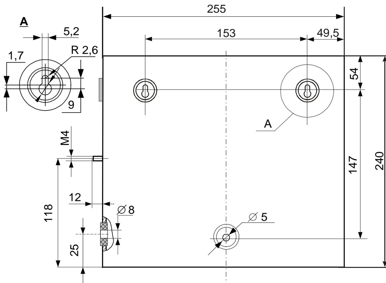
Рис. 12 Габаритные и присоединительные размеры ППК-Е (исп. 1)
