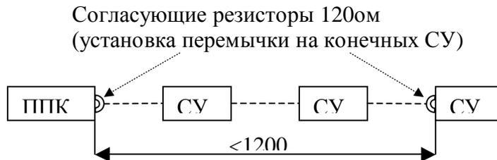
**Рис. 4 Подключение сетевых устройств на линию RS-485.**
