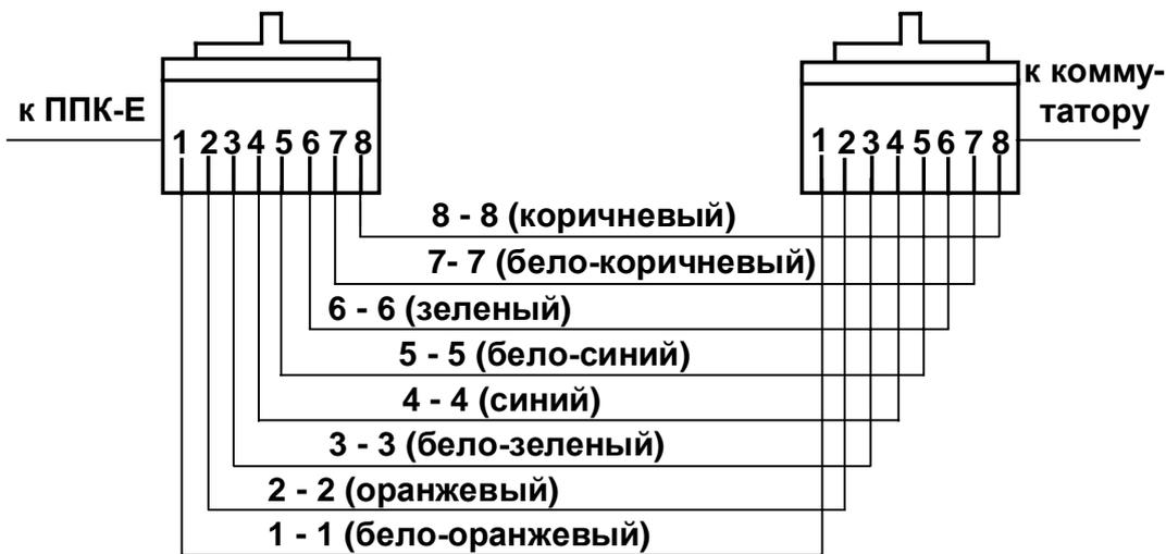
б) Прямой кабель (соединение ППК-Е и коммутатора)
