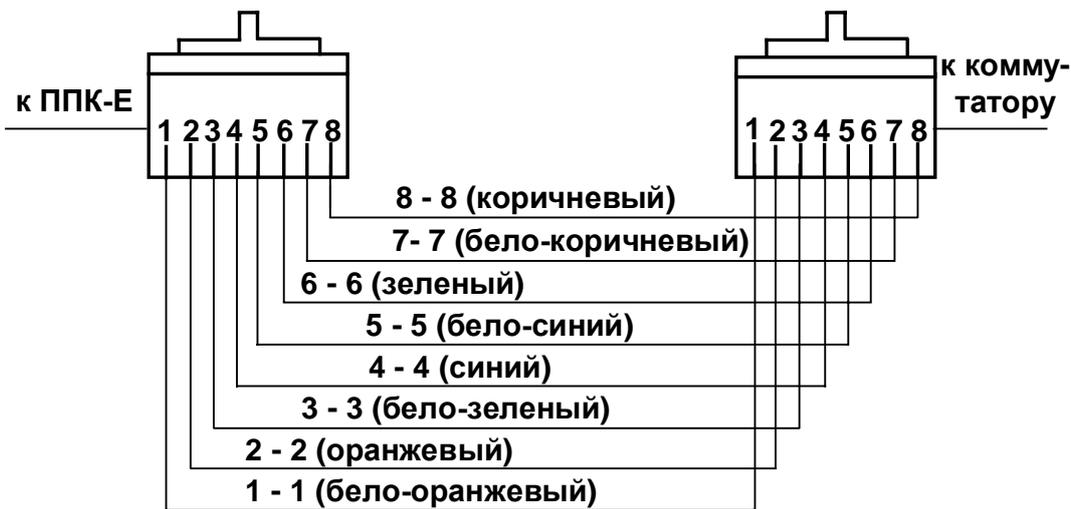
**б) Прямой кабель (соединение ППК-Е и коммутатора)**
