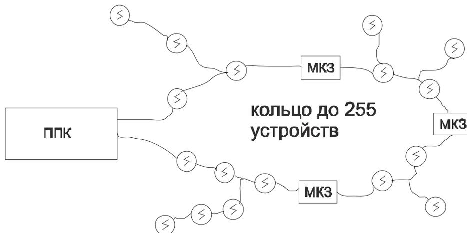
**Рис. 5 Подключение адресного шлейфа в режиме «кольцо».**
