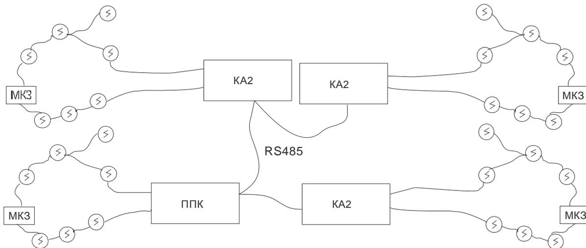
**Рис. 7 Увеличение адресных устройств при помощи КА2**
