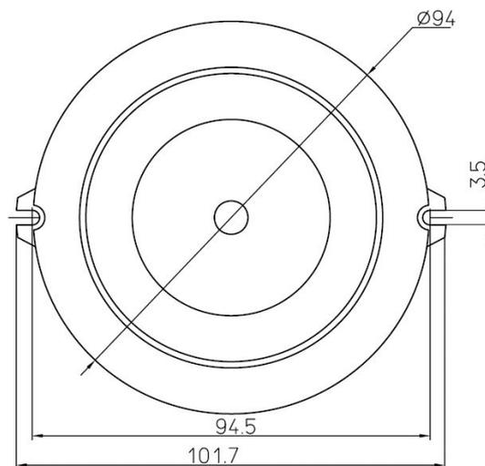
Рис. 3 Габаритные и присоединительные размеры корпуса ОСЗ
