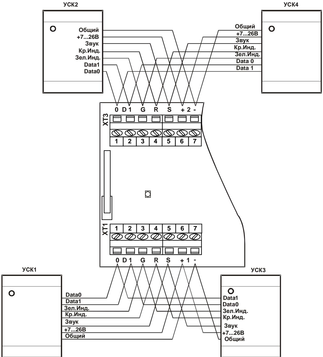
**Рис. 7 Подключение УСК для двусторонней ТД**
