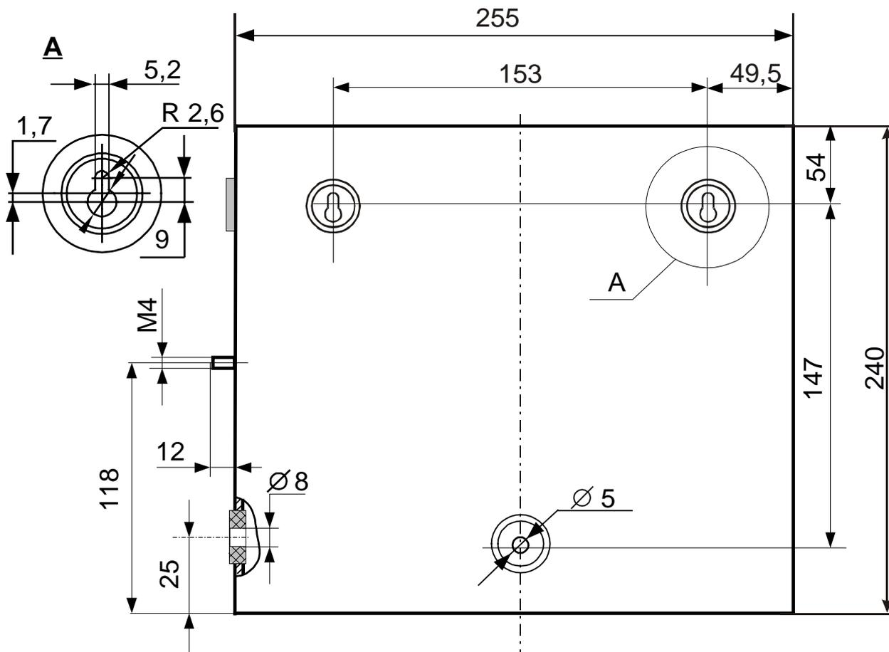
Рис. 10 Габаритные и присоединительные размеры КД2 исп.08-1
