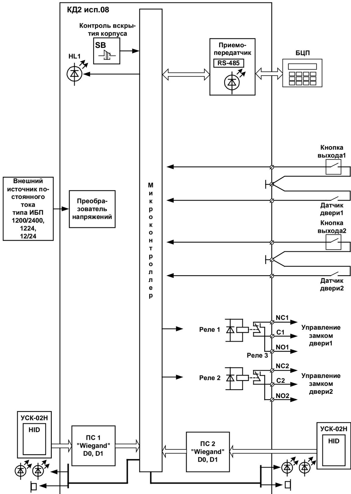
Рис. 5 Схема структурная КД2
