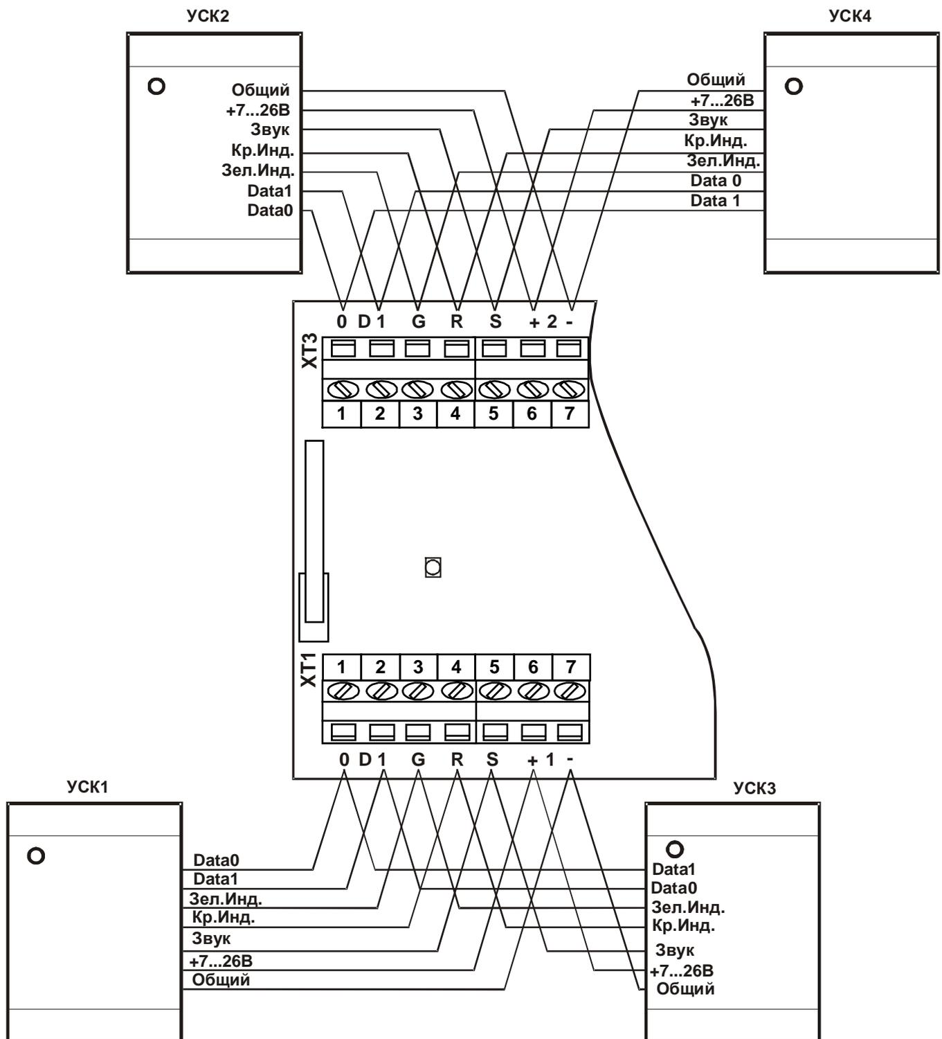
**Рис. 7 Подключение УСК для двусторонней ТД**
