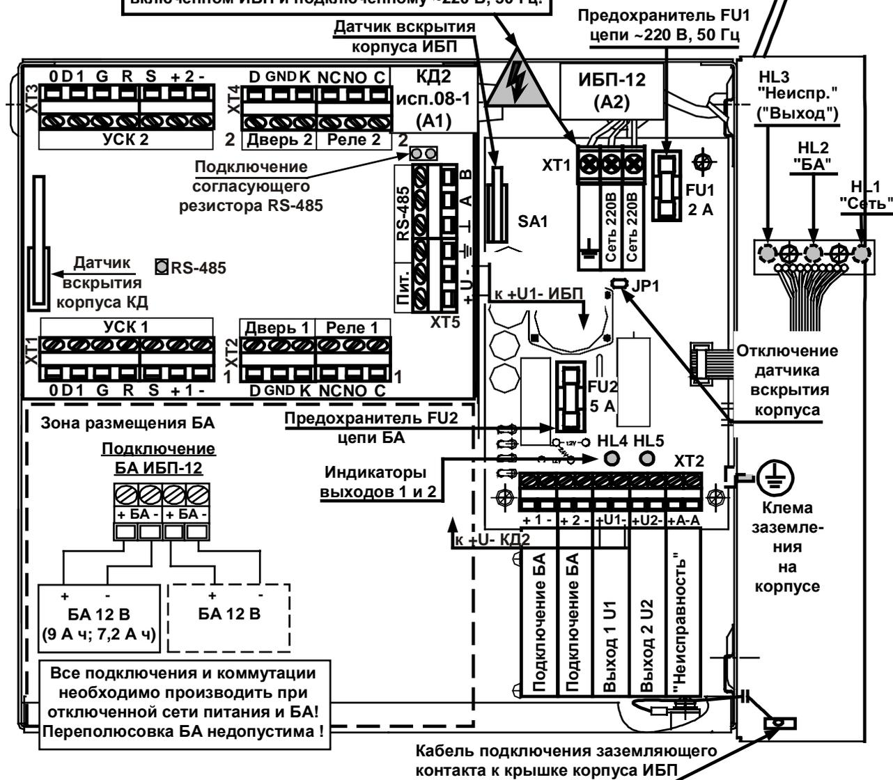
Все подключения и коммутации необходимо производить при отключенной сети питания и БА! Переполюсовка БА недопустима !
