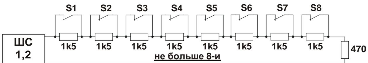
**Рис. Схема 7 Последовательное подключение нескольких НЗ извещателей.**
