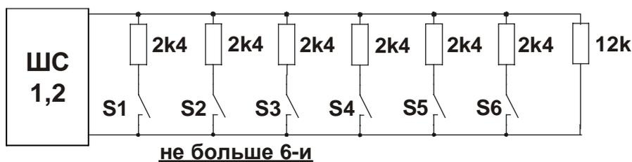
Рис. Схема 8 Параллельное подключение нескольких НР извещателей.
