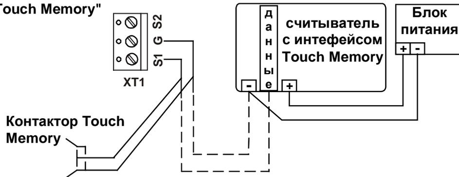
Рис. 10 Подключение контактора или считывателя(пунктиром) Touch Memory
