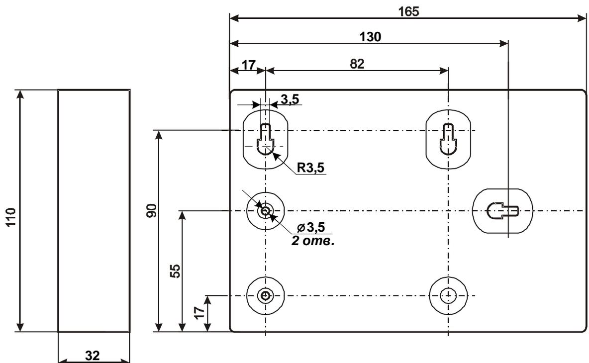
Рис. 2 Габаритные и присоединительные размеры корпуса ИСМ220
