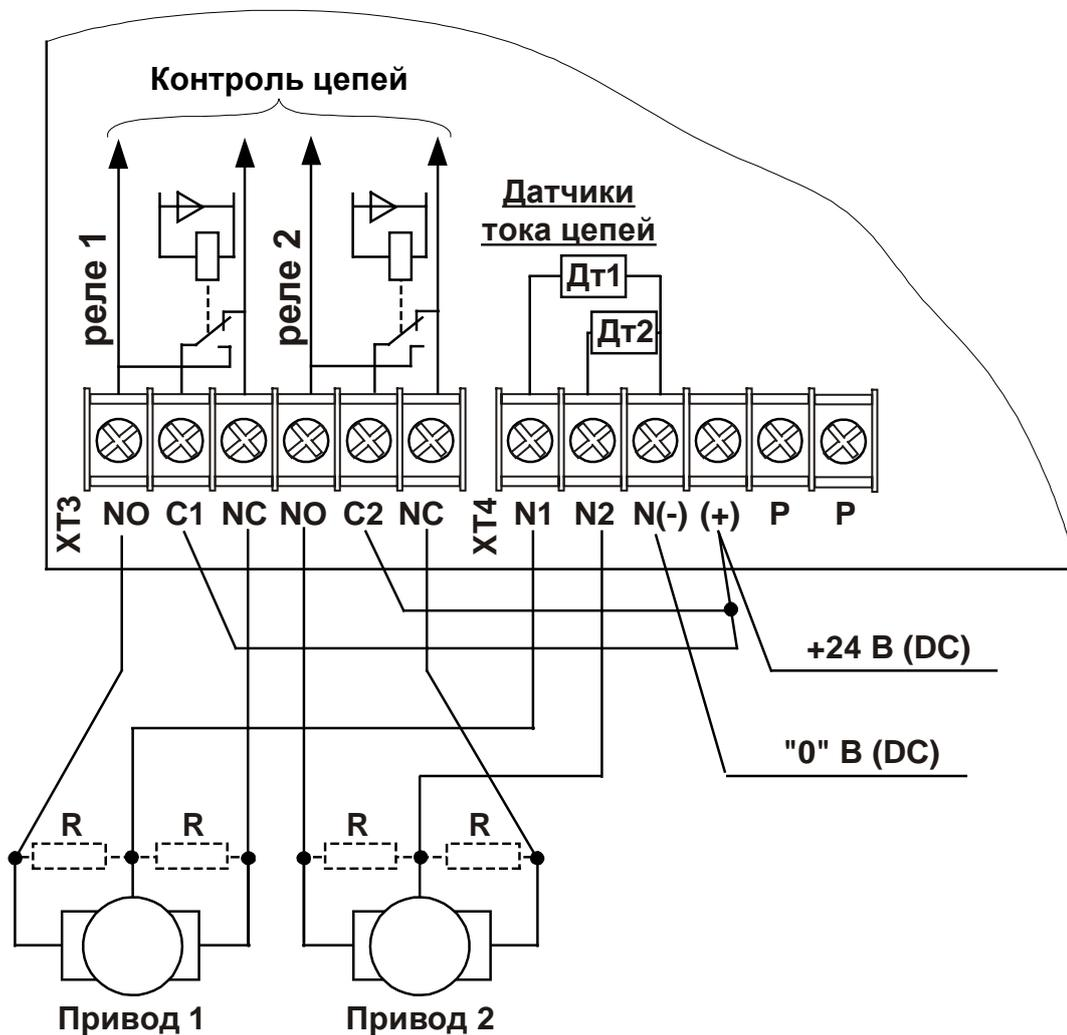
**Рис. 6 Подключение 2-х реверсивных приводов типа Белимо постоянно-го тока 10..40 В**
