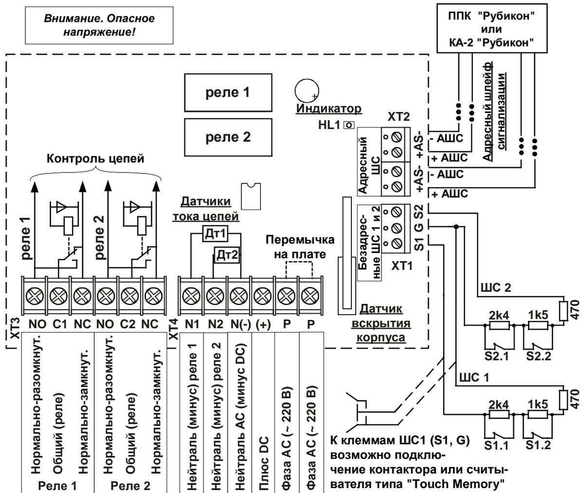
Рис. 1 Внешний вид, расположение элементов, подключение ИСМ220
