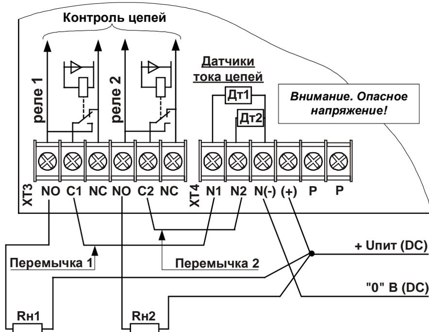
б) Подключение одиночной нагрузки к сети постоянного тока
