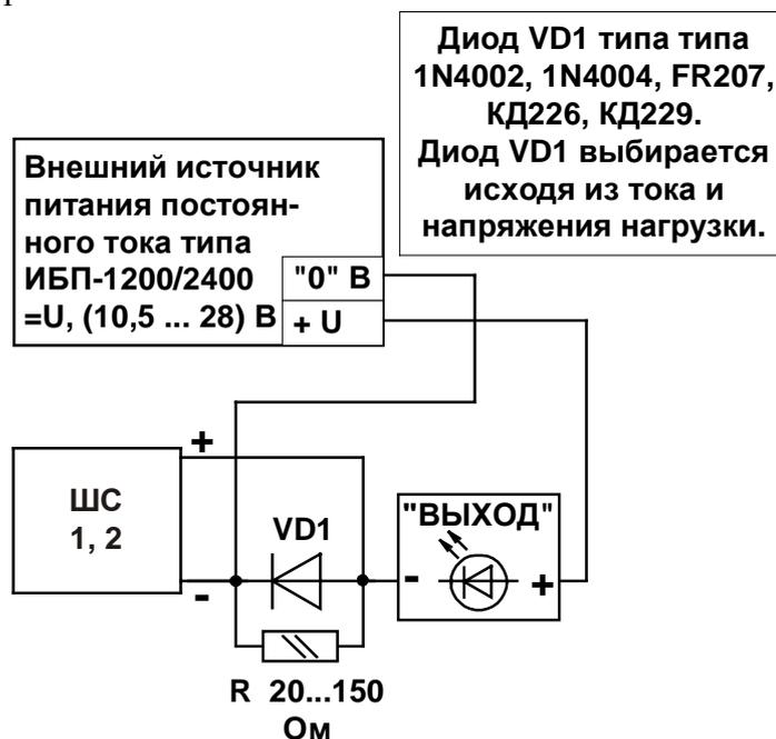
**Рис. 10 Подключение светового оповещателя**
