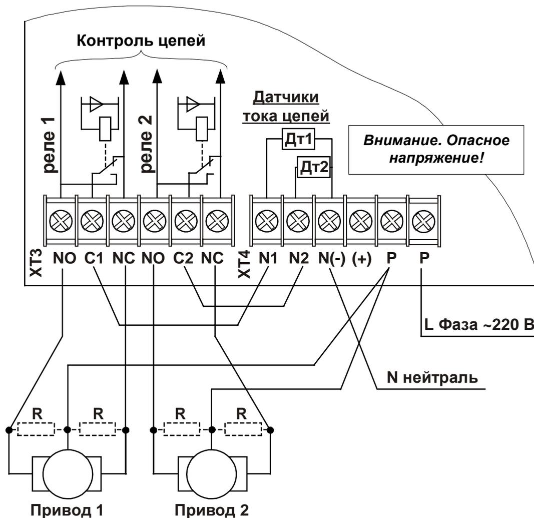
**Рис. 6 Подключение 2-х реверсивных приводов переменного тока типа Белимо.**
