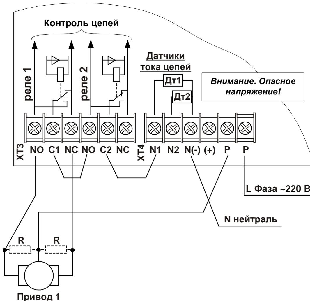
**Рис. 8 Подключение 1-го реверсивного привода переменного тока типа Белимо с возможностью отключения напряжения**
