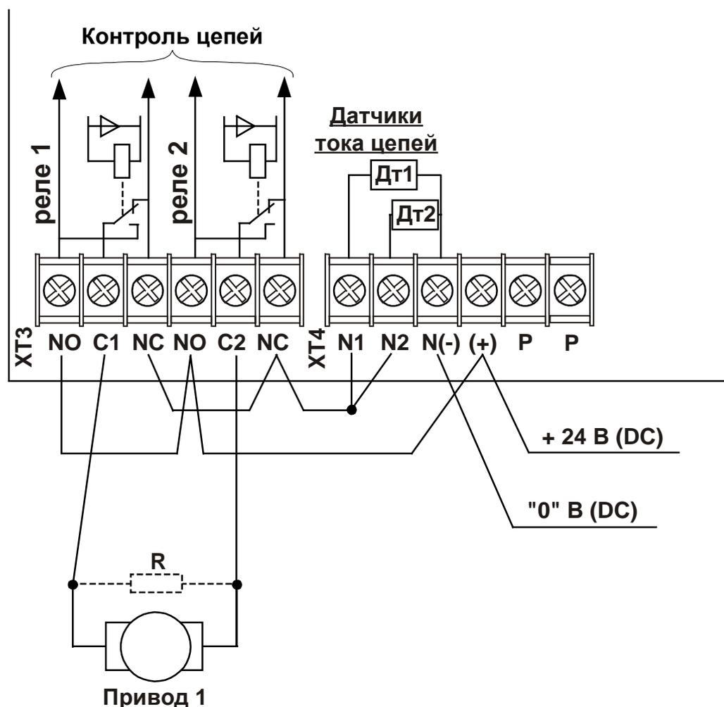
**Рис. 9 Подключение реверсивного привода с переплюсовкой постоянного тока 10..40 В**
