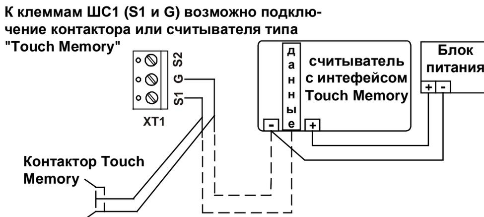
Рис. 11 Подключение контактора или считывателя(пунктиром) Touch Memory
