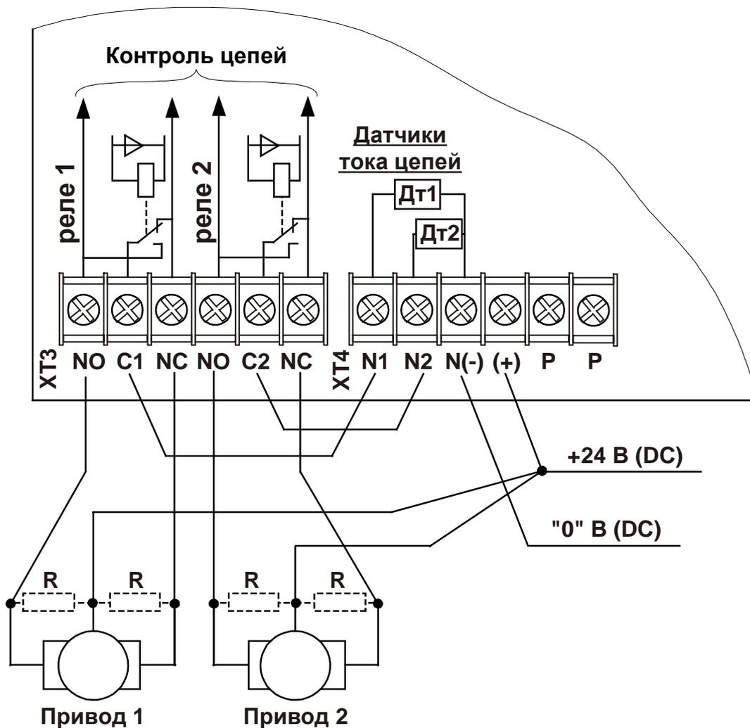
**Рис. 7 Подключение 2-х реверсивных приводов типа Белимо постоянного тока 10..40 В**
