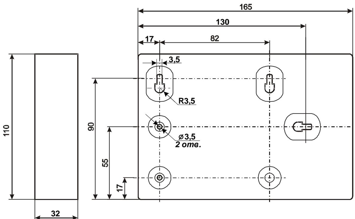
Рис. 2 Габаритные и присоединительные размеры корпуса ИСМ220 ИСМ220 исп.08-4 (IP20)
