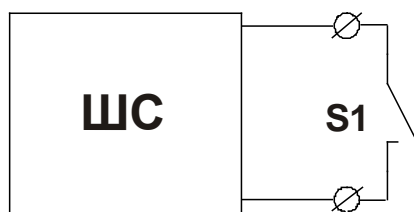
Рис. Схема 4. Подключение извещателя (датчика) с НР контактами без контроля целостности линии связи.
