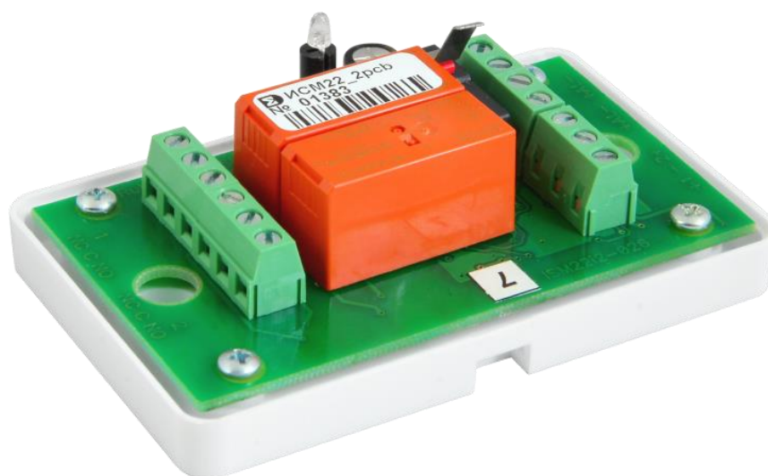
Рис. 1 Внешний вид ИСМ22 со снятой крышкой
