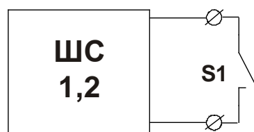
Рис. Схема 6. Подключение извещателя (датчика) с НР контактами без контроля целостности линии связи.
