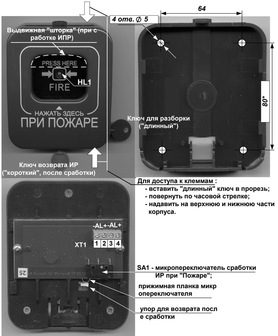
Рис. 1 ИР-П. Внешний вид, расположение элементов
