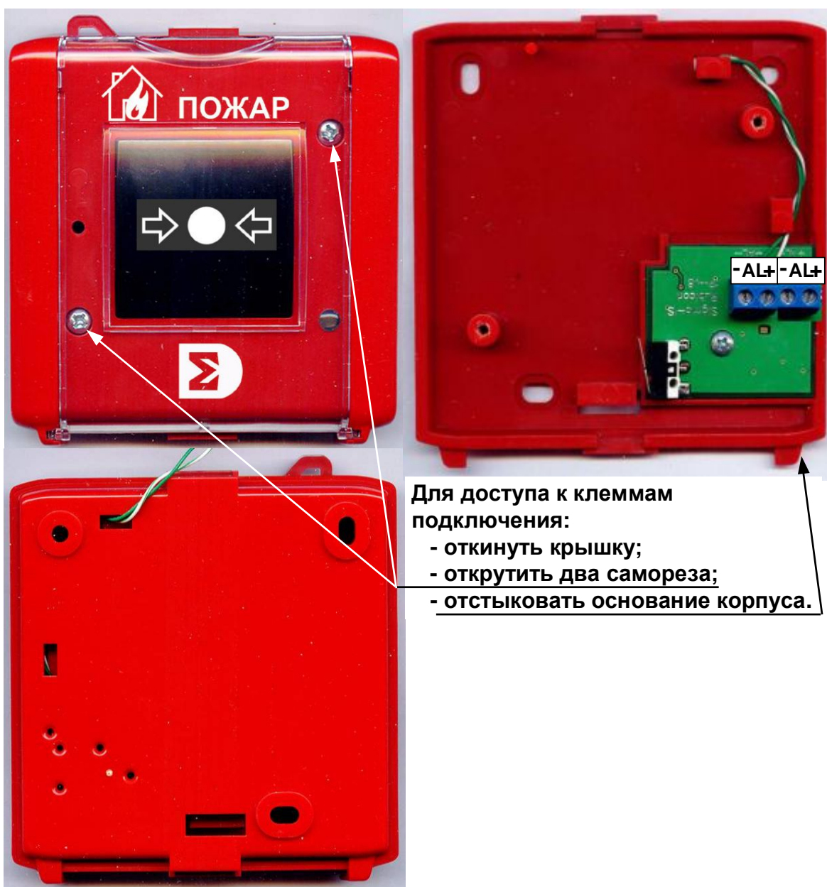
Рис. 2 ИР-П, ИР-П исп.2. Внешний вид, клеммы подключения.
