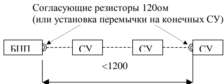
Рис. 6 Подключение сетевых устройств на линию RS-485.
