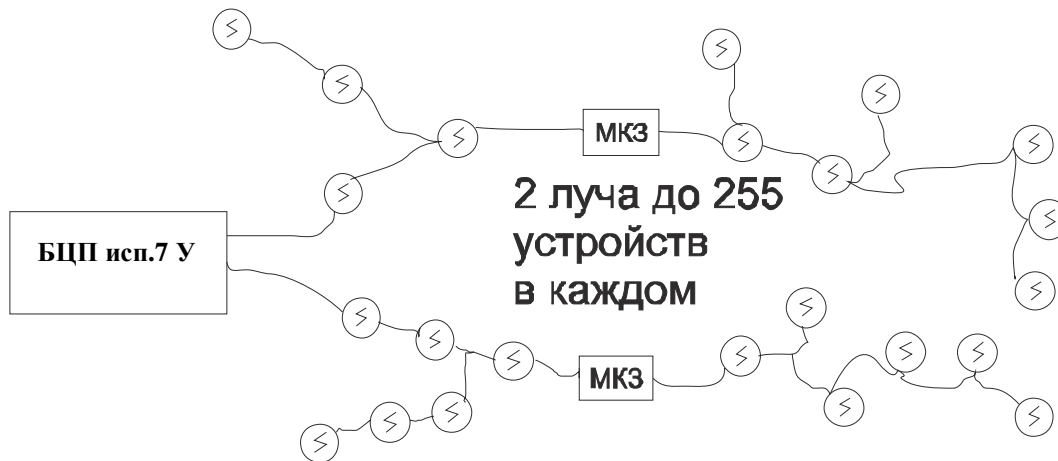
Рис. 6 Подключение адресного шлейфа в режиме «два луча».
