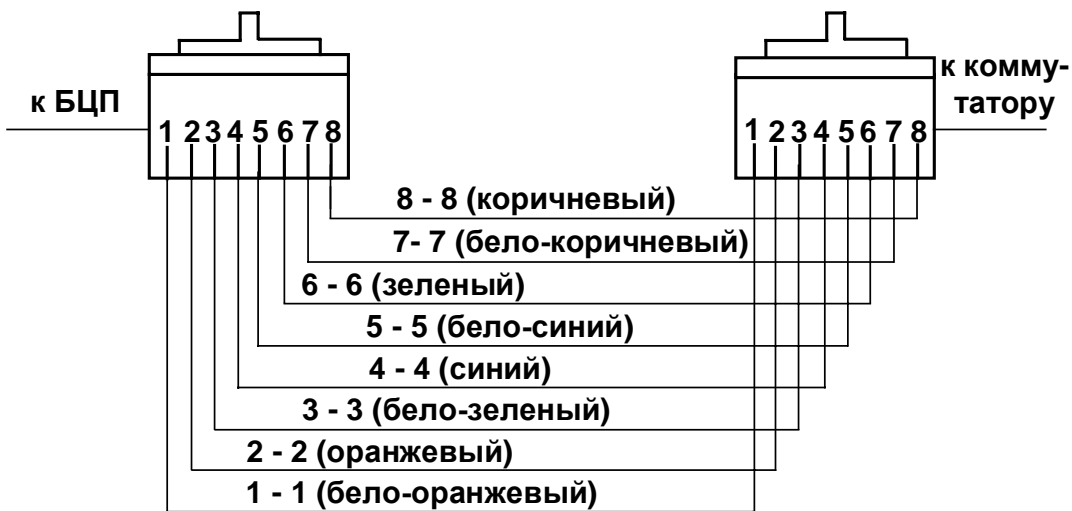
б) Прямой кабель (соединение БЦП и коммутатора)
