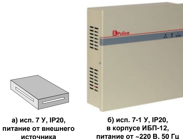
Рис. 1 Варианты исполнений БЦП: а) исп. 7У; б) исп. 7-1У.
