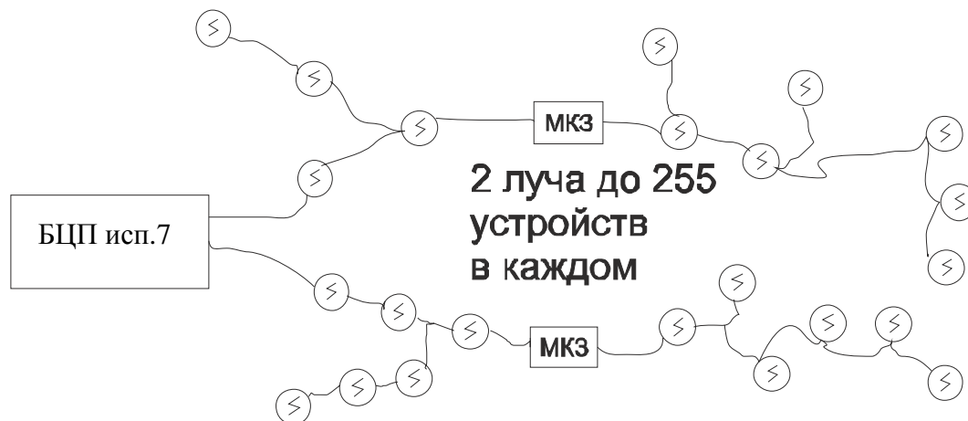
Рис. 5 Подключение адресного шлейфа в режиме «два луча».
